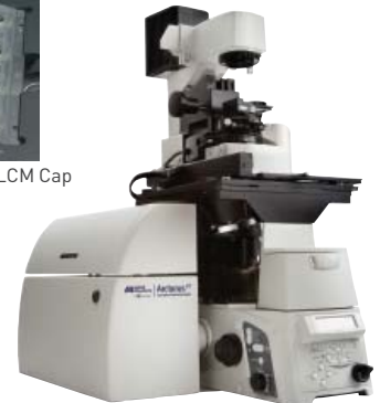
Arcturus XT ™ レーザーキャプチャー マイクロダイセクションシステム
